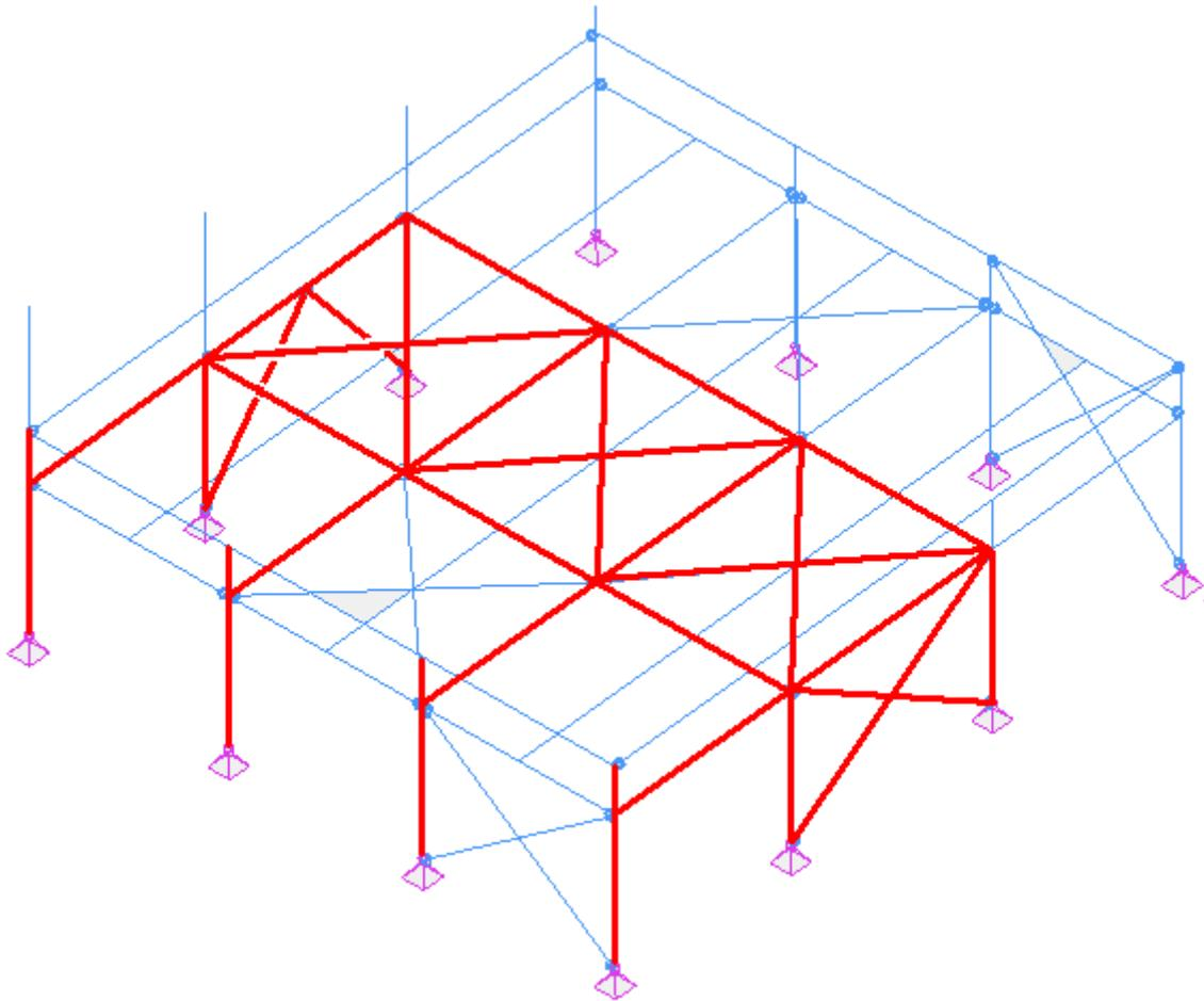
La pression du vent s'exerce sur le bardage qui pousse sur les poteaux et potelet de la face sud.
