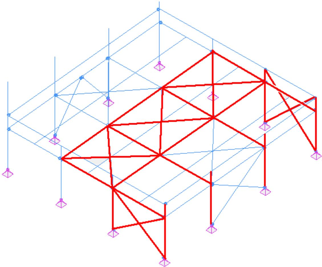
La pression du vent s'exerce sur le bardage qui pousse sur les poteaux et potelet de la face est.
