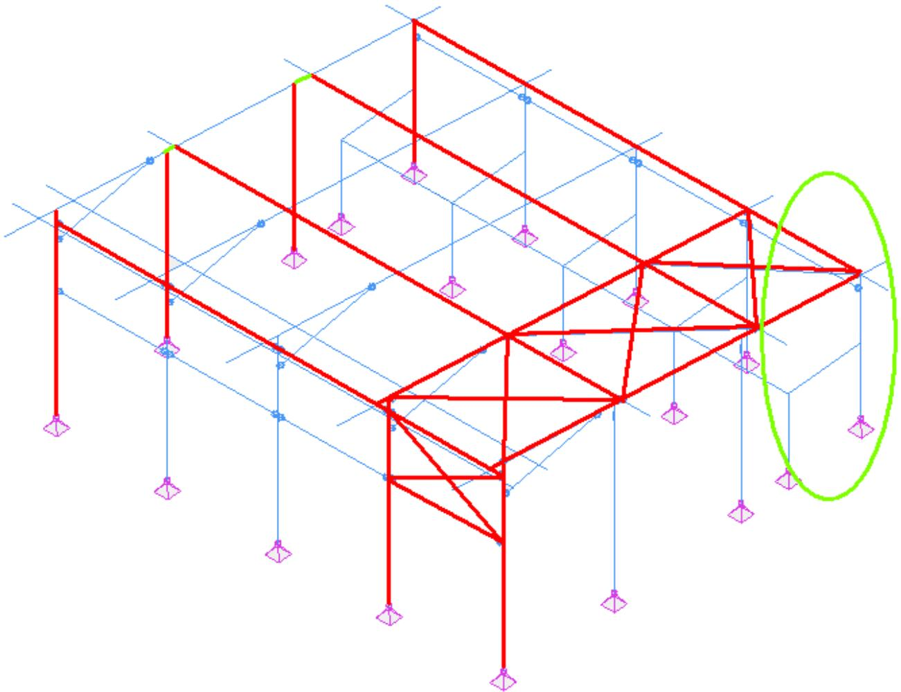
*La pression du vent s'exerce sur le bardage qui pousse sur les poteaux et potelet de la face ouest. La poussée est reprise en pied de poteaux/potelets directement par les fondations.*
