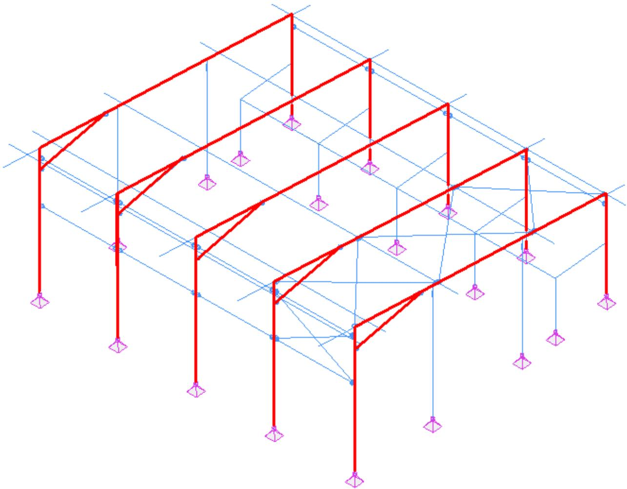
La pression du vent s'exerce sur le bardage qui pousse sur les poteaux des portiques de la face sud. Les portiques sont articulés en pied et encastrés en tête. Ils sont donc indéformables et hyperstatiques. On peut donc les considérer comme des solides. En écrivant l'équilibre de ces portiques, on voit que l'effort exercé sur les poteaux est transmis directement dans les liaisons aux fondations.
