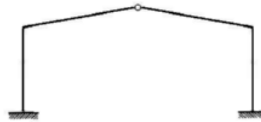
Fig.5.8 : Portique articulé hyperstatique de degré 2
