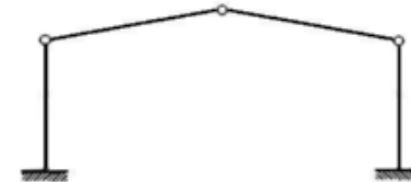
Fig.5.9 : Portique tri-articulé isostatique
