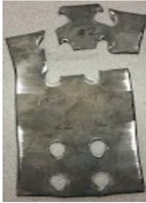
FIGURE 6.13 – Rupture par cisaillement de blocs
