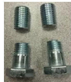
FIGURE 6.16 – Rupture de boulons par cisaillement
