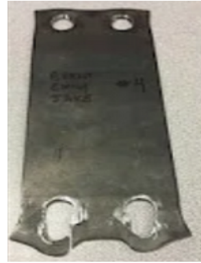
FIGURE 6.14 – Rupture par pression diamétrale
